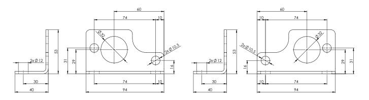
Zur Befestigung einer Einheit werden insgesamt 2 Befestigungswinkel verwendet.
