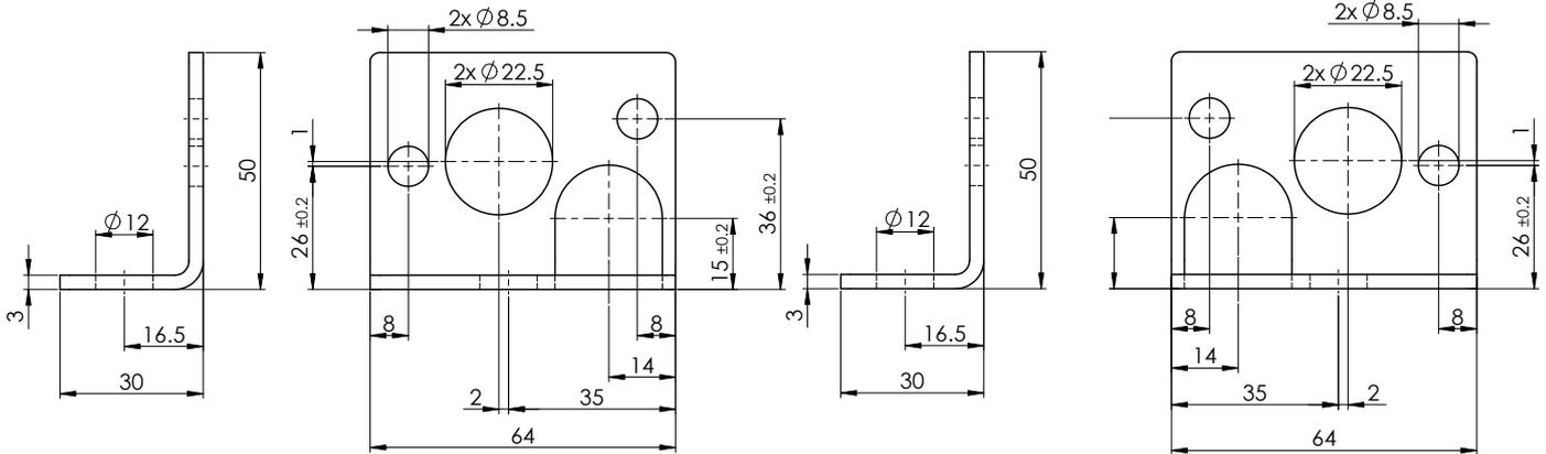
Zur Befestigung einer Einheit der NG3-Mini und NG4-Mini werden insgesamt 2 Befestigungswinkel verwendet.
