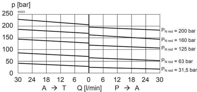
$p_{\text{red}} = f(Q)$  Druck-Volumenstrom-Kennlinie
