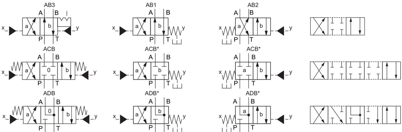
\* Diese 4/2-Wege-Ventile mit Federrückstellung werden als 4/3-Wege-Ventile ausgeliefert.
