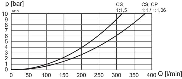
$p = f(Q)$  Druckverlust-Volumenstrom-Kennlinie
