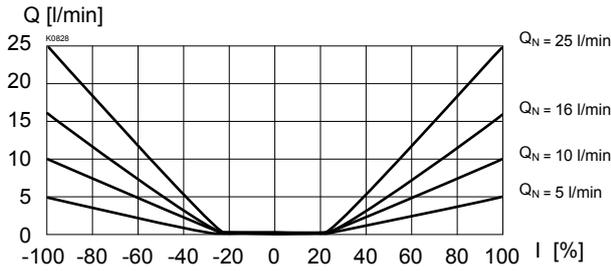
Q = f (I) Volumenstrom-Verstellverhalten ( $\Delta p = 10 \text{ bar}$ )
