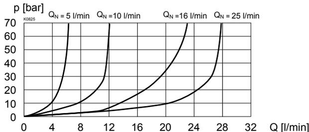
$\Delta p = f(Q)$  Druckverlust-Volumenstrom-Kennlinie ( $l = l_G$ )
