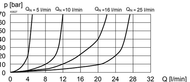
Q = f (I) Volumenstrom-Verstellverhalten ( $\Delta p = 10 \text{ bar}$ )
