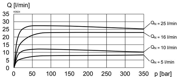
$Q = f(p)$  Volumenstrom-Druck-Kennlinie ( $l = l_G$ )
