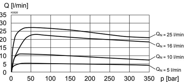
$\Delta p = f(Q)$  Druckverlust-Volumenstrom-Kennlinie ( $l = l_G$ )
