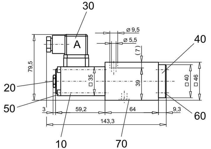
4/3-Wegeventile VWS4.61 für  $Q_N 15 \dots 20$  l/min
