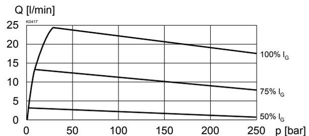
Q = f(I) Volumenstrom-Signal-Kennlinie
