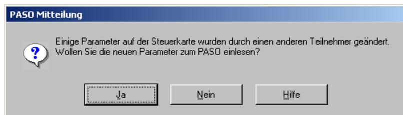
Wird mit "Ja" geantwortet, werden die Parameter neu vom Lageregler PLUS eingelesen. Ev. noch offene Parameterfenster im PASO werden automatisch geschlossen. Erfolgt nach dem Einlesen der Parameter wieder eine Parameteränderung über den Feldbus, erscheint wieder diese Meldung.
