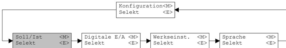
In diesem Fenster werden die Signaltypen vom Soll- und Istwert eingestellt sowie die Zuordnung der Analogeingänge gemacht.
