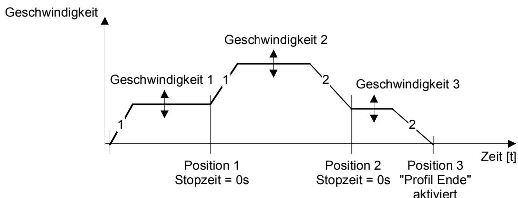
Fahrprofil ohne Stopzeit zwischen den einzelnen Positionen. In diesem Beispiel sind die Regelparameter für ein extrem sanftes Einfahren eingestellt => die Geschwindigkeit kann z.T. nicht erreicht werden. Aus diesem Grund ergibt sich bei der Position 3 eine schlagartige Geschwindigkeitsänderung.
