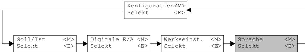
In diesem Fenster kann die Sprache gewählt werden, mit welcher das Menu beschriftet sein soll. In der Version mit Tastatur/Display oder Bedienterminal MTG02 bzw. PC-Terminalsoftware TESO erscheint die Sprachwahl bei einem Neustart des Lageregler PLUS automatisch. Während dem Betrieb kann die Sprache jederzeit im Menu "System" geändert werden. In der PASO-Version wird diese Einstellung automatisch in die Datei "konfig.kon" abgespeichert und beim Neustart übernommen.
