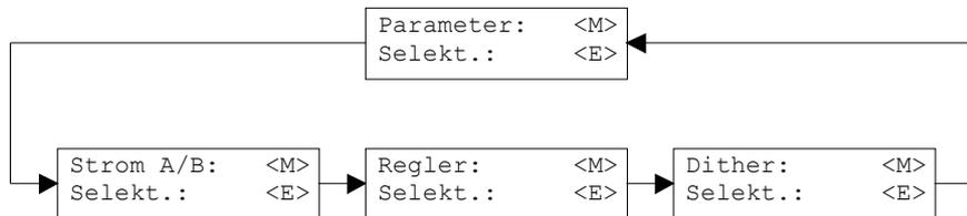
Mit der Taste "MODE" gelangt man von einem Untermenüpunkt zum nächsten. Alle vorhandenen Untermenüpunkte sind im Abschnitt 7 "Einstellungen" mit der Numerierung 7.x.x aufgeführt.
