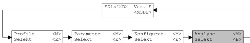
Im Analyse-Menü können Messwerte und ev. vorhandene Fehler auf dem angeschlossenen Lageregler PLUS online angezeigt werden.
