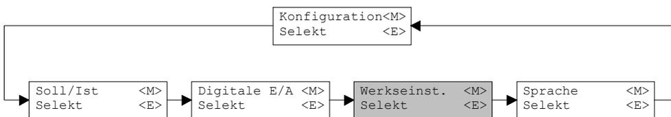
Mit diesem Befehl werden die im EPROM auf dem angeschlossenen Lageregler PLUS abgespeicherten Werkseinstellungsparameter geladen und bei der PASO-Variante zum PC eingelesen.
