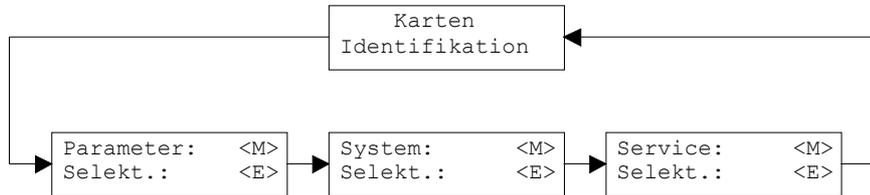
Mit der Taste "MODE" gelangt man von einem Menüpunkt zum nächsten. Alle vorhandenen Menüpunkte sind im Abschnitt 7 "Einstellungen" mit der Numerierung 7.x aufgeführt.
