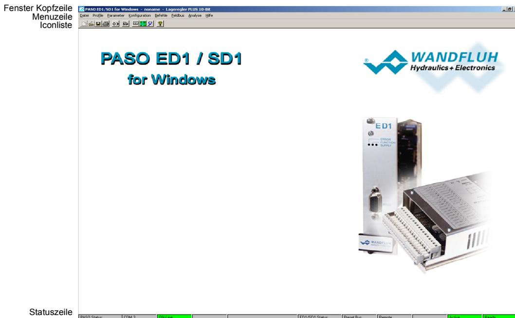
Während des Aufstartens prüft die Parametriersoftware PASO, ob eine digitale Steuerkarte angeschlossen ist. Wenn keine Kommunikation aufgenommen werden kann (Übertragung gestört oder keine digitale Steuerkarte angeschlossen), so erscheint eine Fehlermeldung. Alle Menüpunkte und Tasten, die eine Aktion im Zusammenhang mit der Kommunikation beinhalten, werden dann gesperrt. Alle anderen Funktionen der Parametriersoftware PASO können ohne Einschränkung verwendet werden.
