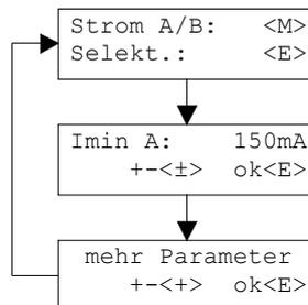
Mit den Tasten "+" und "-" kann der gewünschte Wert eingestellt werden. Mit der Taste "ENTER" gelangt man zum nächsten Parameterwert. Alle vorhandenen Parameter sind im Abschnitt 7 "Einstellungen" in der Spalte "Feld" aufgeführt.
